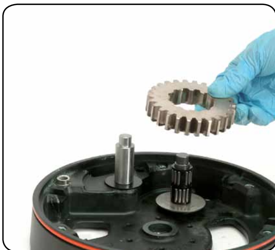
17. Remove the gear n°10
