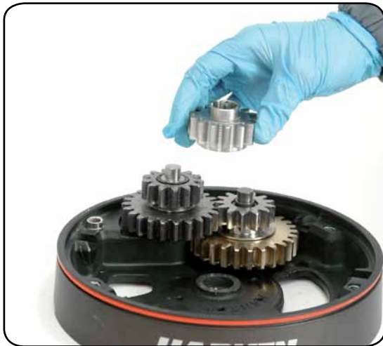
13. Remove the gear n°2
