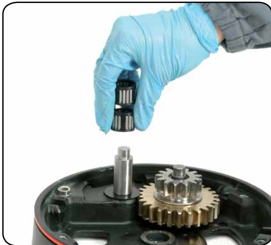
15. Remove roller bearings n°15
