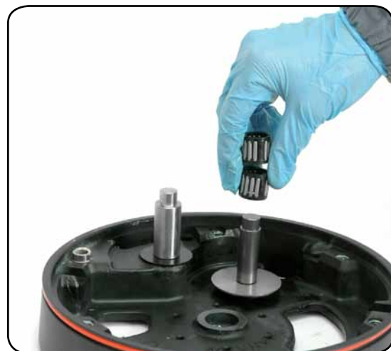
18. Remove roller bearings n°12
